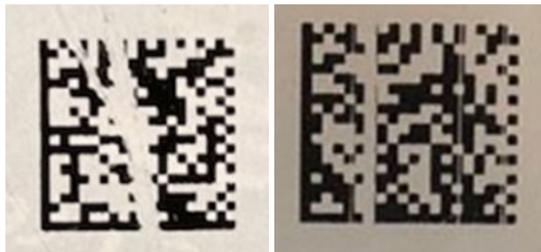
Нарушение целостности КМ*
