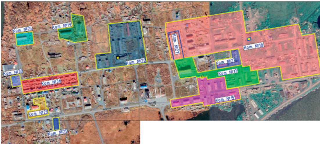
Рис. 2.1 - Зоны действия систем теплоснабжения микрорайона Новый поселок
